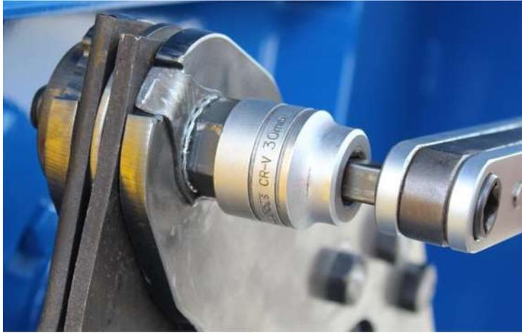
Assurez-vous toujours que la languette de verrouillage soit bien enfoncée dans le renforcement et à l'aide d'une clé à cliquet dynamométrique, assurez-vous que le boulon est serré au réglage recommandé de 647 Nm.
