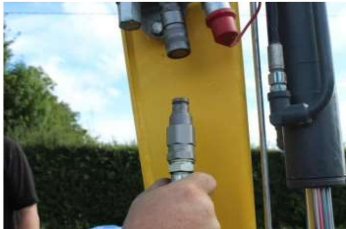
Raccordez les flexibles hydrauliques au circuit auxiliaire de la machine. Assurez-vous toujours de débrancher les flexibles hydrauliques lors du montage / démontage ou du réglage du gyrobroyeur/épareuse.
