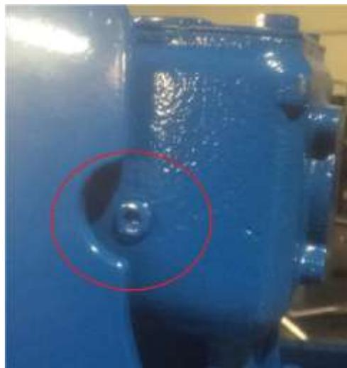
Assurez-vous de réinsérer les deux bondes et de les serrer pour éviter les fuites. Remettez le capot avant en place en vous assurant que les boulons soient bien serrés.
