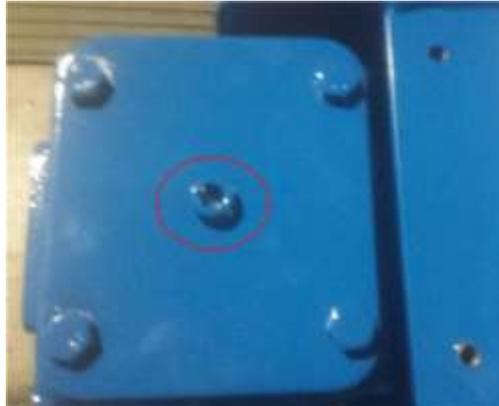
Lorsque l'huile est vidangée, ramenez la tête du FH100 en position verticale. Desserrez le bouchon de l'indicateur de niveau d'huile situé sur le côté du multiplicateur de vitesse et commencez à remplir par le haut avec de l'huile EP 80W / 90 jusqu'à ce que l'huile atteigne l'indicateur de niveau d'huile.
