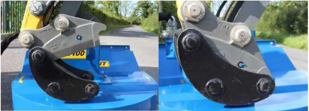
Lorsque le support de montage est en place, procédez comme sur la photo pour le soulever comme si vous preniez un godet. Assurez-vous que l'attelage est libre de tout obstacle et que les flexibles hydrauliques ne peuvent pas être pincés lors du raccordement au support de fixation.
