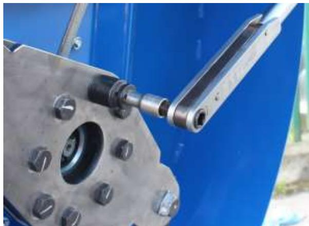
Avec un clé à cliquet dynamométrique, assurez-vous que les écrous et les boulons soient serrés au couple recommandé de 33 Nm.
