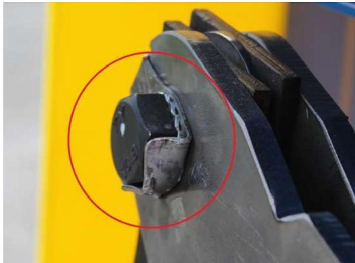
Pour vérifier si les lames sont bien serrées ou pour les remplacer, vous devrez abaisser la languette de verrouillage sur le boulon. Veuillez noter que lors du remplacement des lames, la patte de verrouillage doit également être remplacée et ne peut plus être utilisée.
