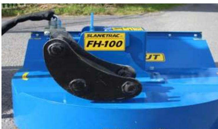
Pour installer le gyrobroyeur FH100 sur votre machine, commencez par placer le support de fixation dans la position souhaitée.
