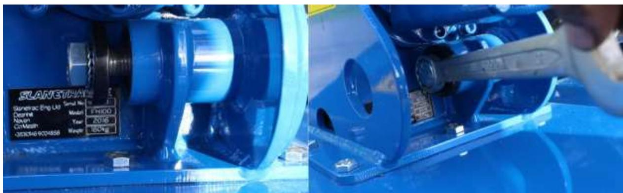
Une fois le support d'attelage en place, serrez le boulon de verrouillage avec une clé plate de 30 mm pour le fixer en place.
