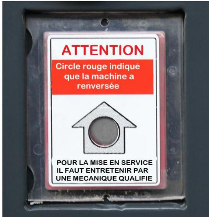
*Si le machine est renversé, Slanetrac ou ses agents doit en être notifié . Si vous ne le faites pas, la garantie de la machine deviendra nulle et non valide*
