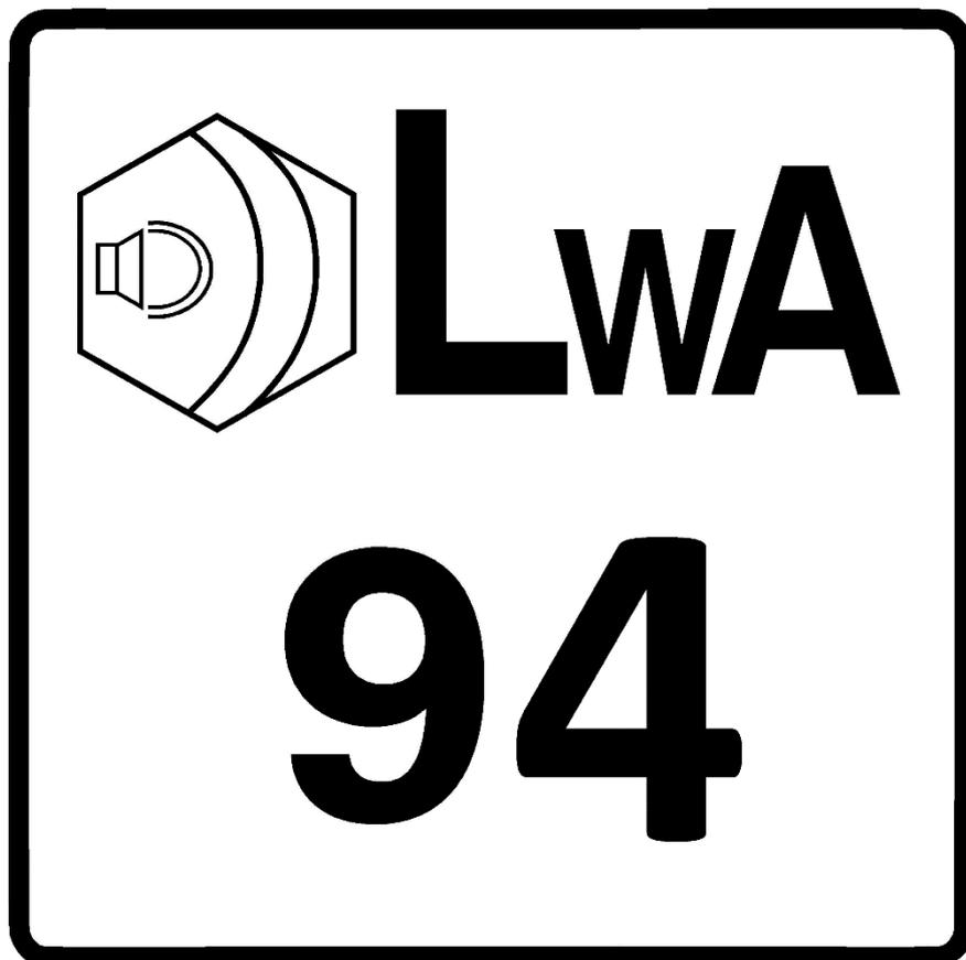
Informations sur l'enquête acoustique pour la pression sonore rpar la directive 2006/42/ce est fourni sur L'étiquette A. Comme le seuil de 94 dB (A) a été enregistré, il est nécessaire de mesurer la puissance acoustique et les détails sont fournis sur l'étiquette B.
